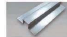
Perfil omega (junta) Acero galvanizado z-275 50 x 40 x 40 x 40 x 50 Esp.= 1,5 L= 3 m L max.= 4 m
