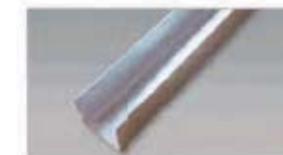
Perfil "U" (intermedio) Acero galvanizado z-275 40 x 40 x 40 Esp.= 1,5 L= 3 m L max.= 4 m
